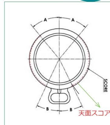
**WQ (クイック) キャップ** タブを上を持ち上げて、側面の「スリット」から開封するタイプのキャップ。
