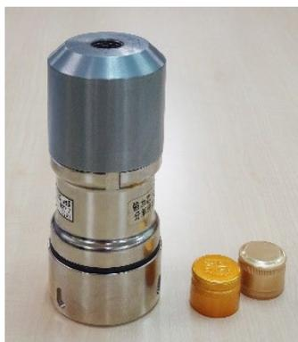
「flat KT x JH」は従来の「KT+KS」とクリンプ位置は同じですが、キャップ天面の形状が異なるのでプレッシャブロックの交換を推奨します。
