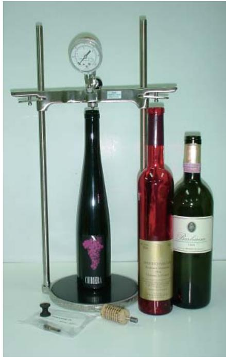
■ワインの品質管理に充填後のヘッドスペース圧の抜き取り検査は不可欠です。使いやすさで定評あるアメリカ Zahm & Nagel 社製穿孔圧力計の「ワインコルク用」をご紹介します。オプションの減圧ゲージと付け替えれば熱充填されたワインの減圧も測定できます。
