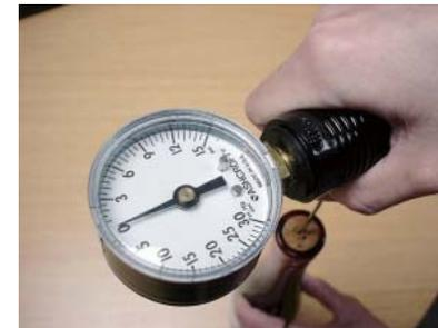
■ワインの品質管理に充填後のヘッドスペース圧の抜き取り検査は不可欠です。「持ちやすい形状のグリップ」と「細い穿孔針」で、片手の操作力でワインコルク栓を貫してびん内の減圧または圧力を測定できます。アメリカ TCW 社製。2000 年からモデルチェンジした改良型です。
