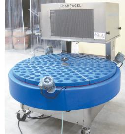
■ブラインリンサー □びん口と王冠に付着したブラインを 水で洗い流すトンネル
