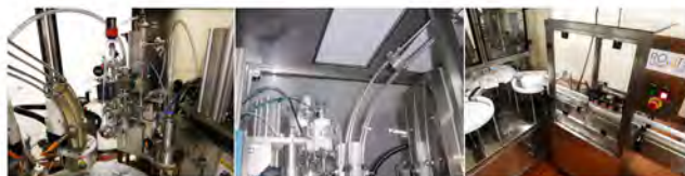
ハイ・ガスボリュームの製品でも安定して充填ができるシリーズVの新型充填バルブ。(写真のモニターコントロールバルブはオプション。)
