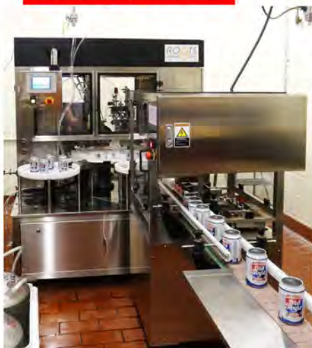
(写真上・下) ミルノメーカーのミルノークス研究所にて、「ビアラディクスIV」(奥)と「3ヘッドポンプ」(手前)を組み合わせた事例。パイロットプラントで醸造されたビールの充填に使用。
