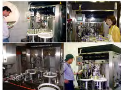
ハイ・ガスボリュームの製品でも安定して充填ができるシリーズVの新型充填バルブ。(写真のモニターコントロールバルブはオプション。)
