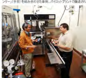
(写真上・下) ミルノメーカーのミルノークス研究所にて、「ビアラディクスIV」(奥)と「3ヘッドポンプ」(手前)を組み合わせた事例。パイロットプラントで醸造されたビールの充填に使用。
