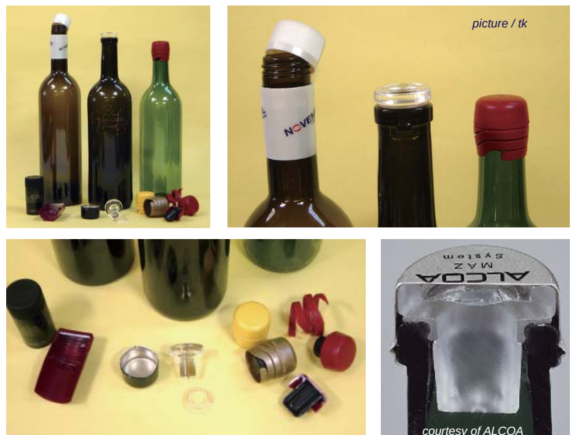
写真8: コルク栓の第四勢力 写真3枚とも左から、Novatwist、Vino-Lok、ZORK。右下の写真はVino-Lokの断面。ガラス、パッキン、外装アルミキャップシェルの3パーツ。ガラスより廉価なPlexiglass仕様も投入。2007年現在、パッキン部分の材質変更や、通常のワインキャップシールを使用できるような変更を検討中と聞いています。アメリカ名称はVino-Seal。
