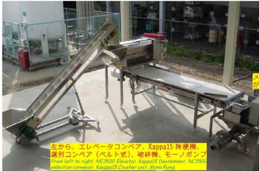
左から、エレベータコンベア、Kappa15 除梗機、選別コンベア（ベルト式）、破碎機、モノポンプ
