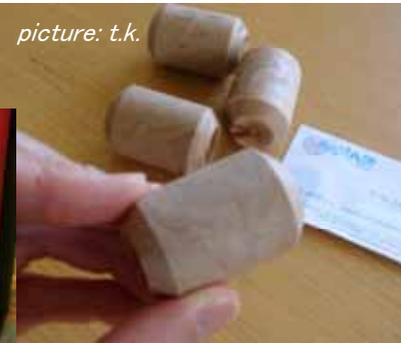
シャンパン用の合成コルクもある。樹脂材料の炭酸ガスバリア性がポイント。
