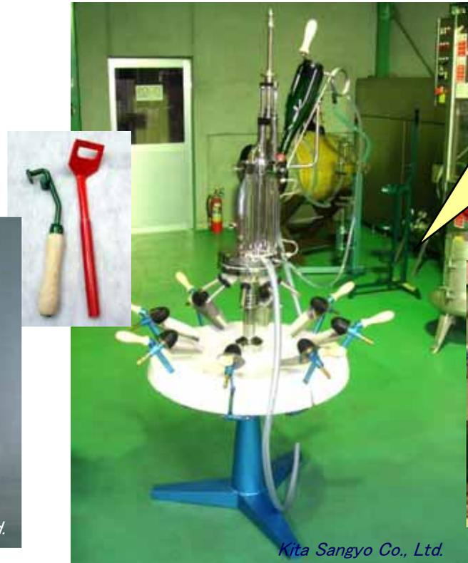
小規模シャンパンハウスの定番ドーサーだった回転式グリリアは現在生産中止だが、リビルト機が手配可能。
