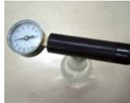
コルク栓の内圧テスター: 穿孔針でコルクを貫通させて内圧を測定。のゲージは、陽圧・減圧の両方が測定可能。(写真は減圧を示している。)
