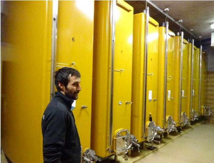
次の部屋。ぎっしりタンクを並べている。手前に地下 1 階の通路があって、そこからレールに乗った「かご」でタンク上部を移動して作業。左列は自動パンチダウン装置付きのタンク。
