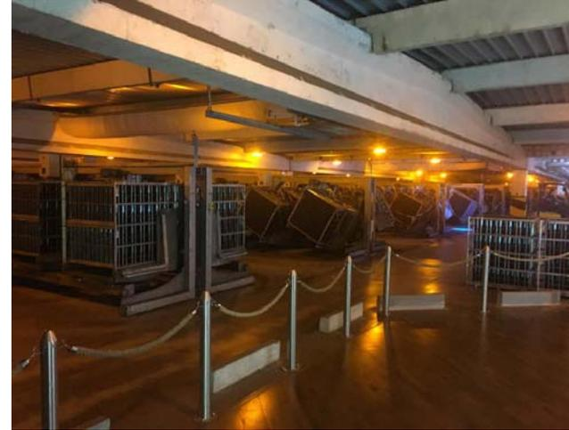
高速の自動充填ラインは、国内大手ビールメーカーの工場を彷彿とさせます。ティラージュを終えたワインを充填し、ビデュールと王冠を打栓した壺が、すごいスピードで出てきます。
