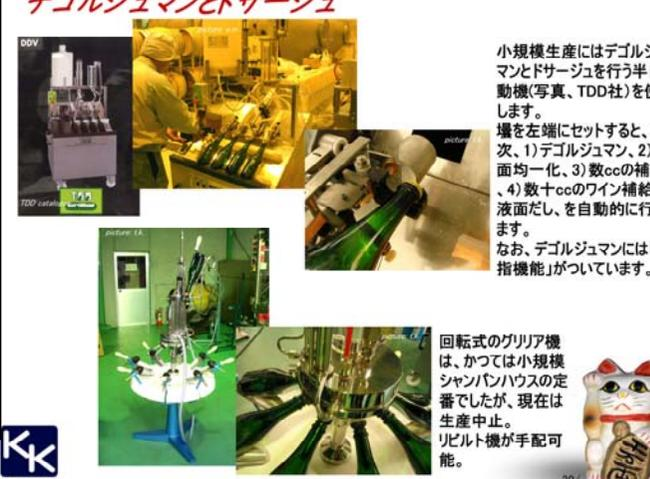
小規模生産にはデゴルジュマンとドサーージュを行う半自動機(写真、TDD社)を使用します。壺を左端にセットすると、順次、1)デゴルジュマン、2)液面均一化、3)数ccの補糖、4)数十ccのワイン補給と液面だし、を自動的に行います。なお、デゴルジュマンには「親指機能」がついています。
