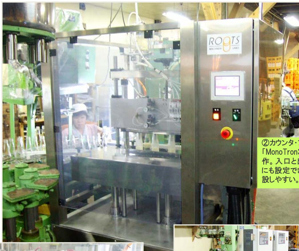
②カウンタ・プレッシャ充填機、モデル「MonoTron3」:タッチパネルによる操作。入口と出口が同じ側にも反対側にも設定できるので、既存ラインに併設しやすい。(この事例は同一側)
