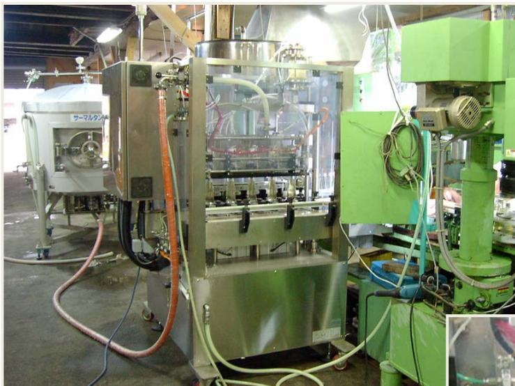
③「MonoTron3」の5本ヘッドの充填部のクローズアップ。圧力センサーで液面を感知する方式。
