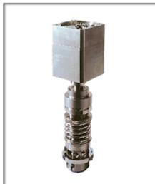
ブラシレスモーターヘッドは PLC 制御による精密なキャッピングを可能にします。
