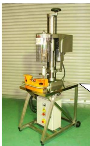
W カムを搭載しない、通常の「TM-3」。精度が高く、安定した巻き締めが可能。堅牢な作り。
