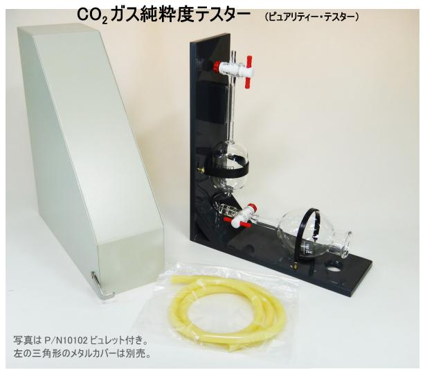
苛性ソーダ溶液で二酸化炭素を吸収し、炭酸ガスの純度を極めて高精度に測定する器具。必要なレンジや読み取り精度に応じた 5 種類のビュレットが選択できます。
