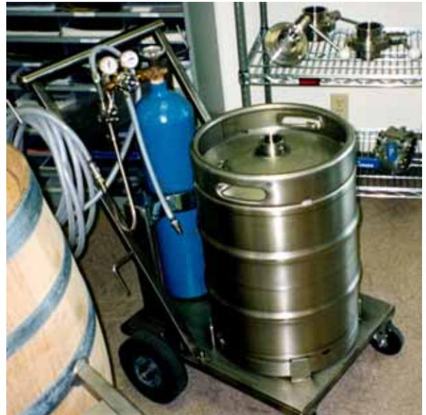
構成部品: 「15 ガロンの SS 樽(ガス供給口、安全バルブ、製品取り出し口)」、(左)と「トッピングガン」(下)
