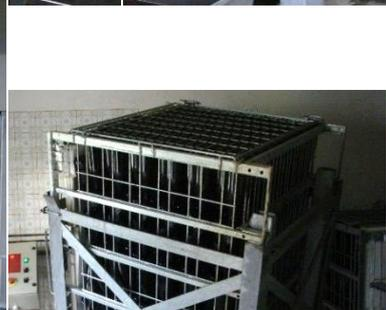
①「ドメヌ・デュポン」の周りには整然と植えられたリンゴ畑。②③シードル用のリンゴには数種類あるが、どれもこんなに小さい。地面に落ちた状態でしばらく熟成させる。④大型トラクターで集めたリンゴはまずは水洗い。⑤緑色の機械が粉碎器。縦型オーガで筒内を上を移動させながら水切りし、最上部にある回転刃で粉碎。⑥こんな円筒形回転刃が内蔵されている。⑦デュポンではメンブランプレスで搾る。私はワイン用のメンブランプレスでリンゴを搾った体験があるが、目詰まりして大変だった。たぶん、リンゴ専用で工夫されたプレスなのだろう。ワイン用のプーハーはフランス製だが、このプーハー・プレスはスイス製。⑧デュポンではびん内二次醗酵のシードルも作る。ジロパレットで澱を下げ、びん口を凍らせて澱を抜くのはシャンパーニュと同じ。
