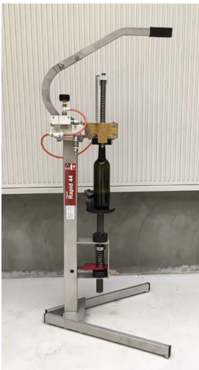
左: Model 44 オプションの「エア駆動バキューム発生器」搭載モデル
