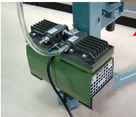
「電動バキュームポンプ」
