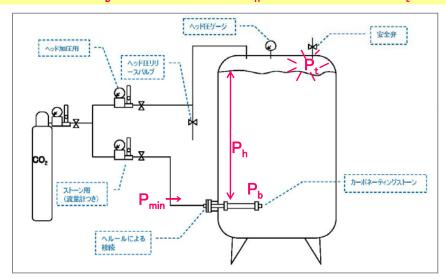
ストーン自体にはブレークスルー圧(またはウエットプレッシャ)と呼ばれる、微 少孔の毛細管現象による抵抗(通常0.2-0.5kg/cm²程度)があります。そ れに加えてストーンより上の液体の圧力(ほぼ1mごとに0.1kg/cm²)、タンク のヘッドスペース圧力を加算したものが、泡を出すための必要圧力です。
