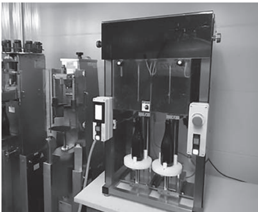
図6 代表的な半自動充填機・ルーツ機械研究所製 BF
