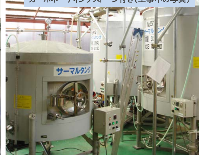
①二次醱酵・ガス添加のためのサーマルタンク、カーボネーティングストーン付き(工事中の写真)
