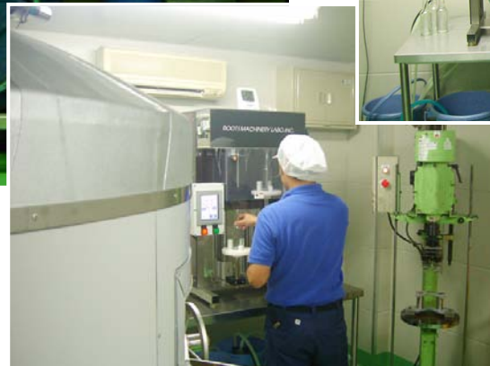
② 2本ヘッド・マニュアル・カウンタープレッシャ充填機、モデル「BF」と、「28mmPPキャップ」による充填作業
