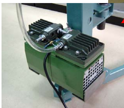
「電動バキュームポンプ」
