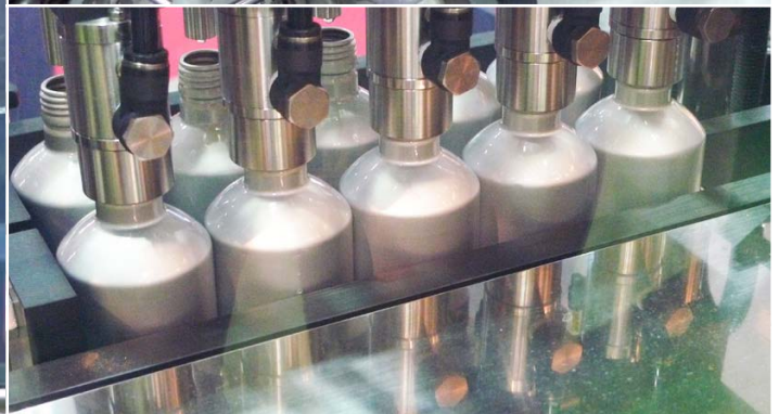
5 本毎にエアリンス。充填は、ノズルヘッドが容器に接触しない方式。
