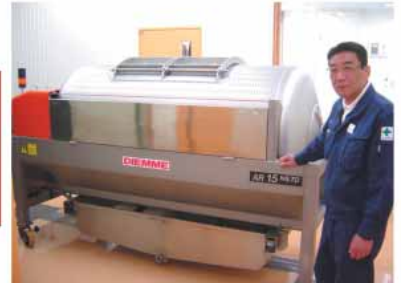
●Fワイナリーにご採用いただいた、AR 15 NS-TD (開放型 1500リットル) 「開放型」はタンク側面にスリットがある形式で、素早い搾りや洗浄性がメリットです。
