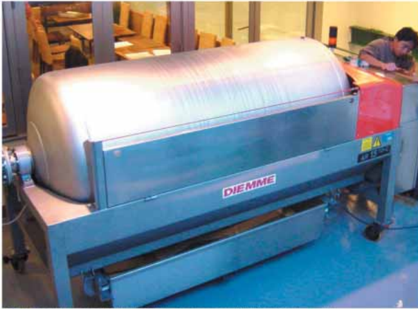
●Vワイナリーにご採用いただいたAR 15 TD-C (閉鎖型 1500リットル) 「閉鎖型」はタンク内にドレーンチャンネルをもうけた形式で、酸化防止がメリットです。
